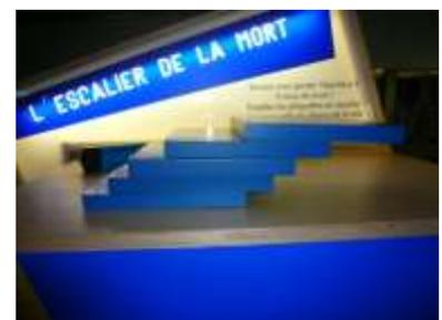
**Pour comprendre :** La plus haute plaquette peut dépasser de  $\frac{1}{2}$  celle sur laquelle elle repose, mais cette 2<sup>ème</sup> ne peut dépasser que de  $\frac{1}{4}$  pour que le centre de gravité de l'ensemble reste au-dessus de la 3<sup>ème</sup>, et cette 3<sup>ème</sup> doit dépasser au maximum de  $\frac{1}{6}$  et la 4<sup>ème</sup> de  $\frac{1}{8}$ .
